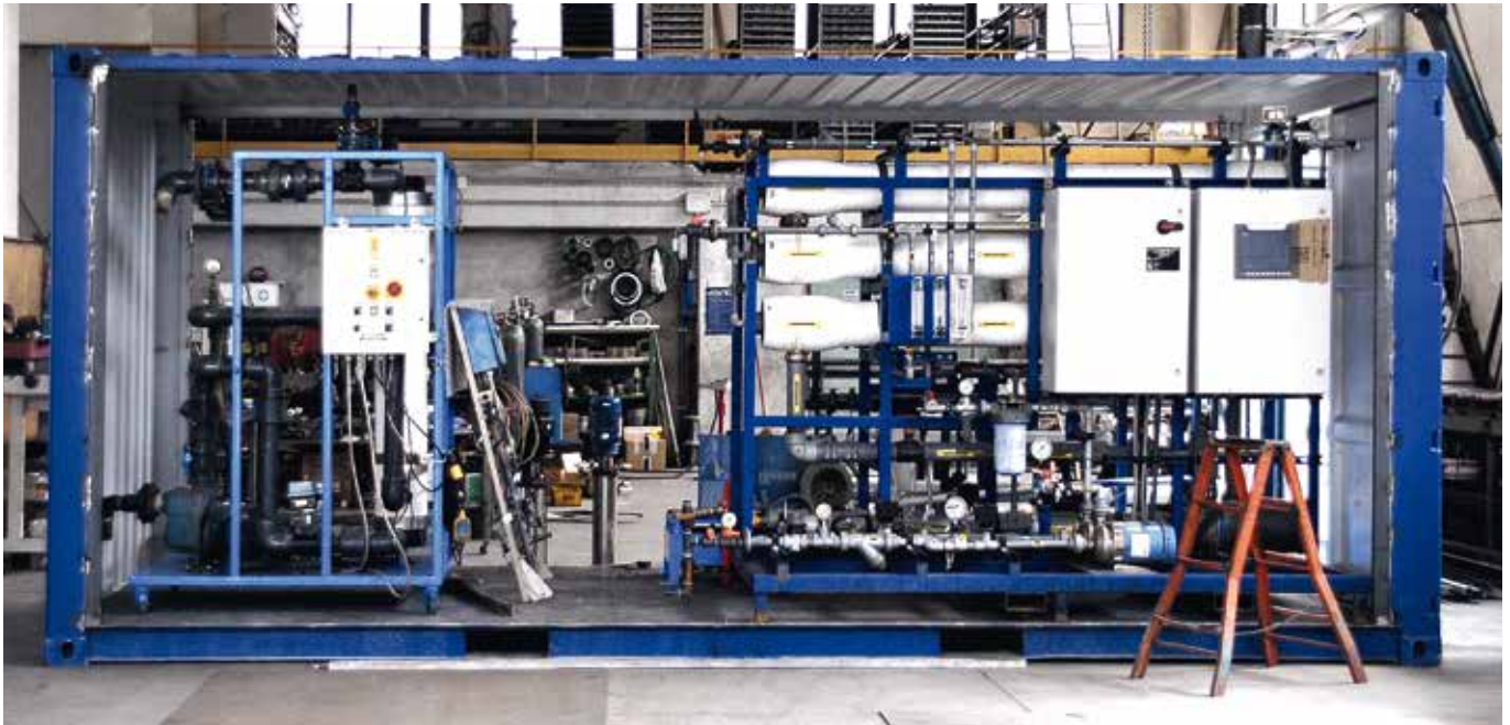
Unità mobile di UF, seguita da FO/RO e RO 2° e 3° passo (da refluo ad acqua pro-demi).
